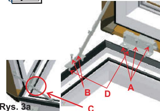
Demontaż skrzydła przeprowadzić w pozycji zablokowanego ogranicznika otwarcia/zamknięcia **C** jak na rys. 3. Wykręcając kolejno wkręty zawiasów **A** oraz wkręty ogranicznika **B** wyjąć z ościeżnicy. Odkręcić dolną i górną listwę transportową od kątowników montażowych.
