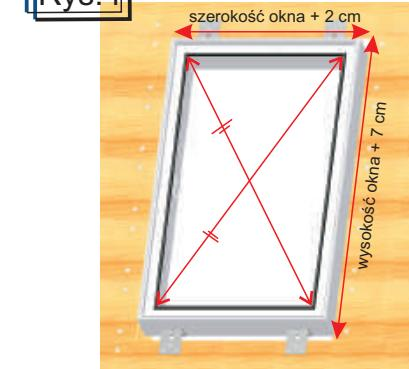
Przygotować otwór pod ościeżnicę w wieżbie dachowej jak na rys. 4. Do istniejących lat przykroić ościeżnicę, wkręcając po trzy wkręty w każdy kątownik montażowy.
