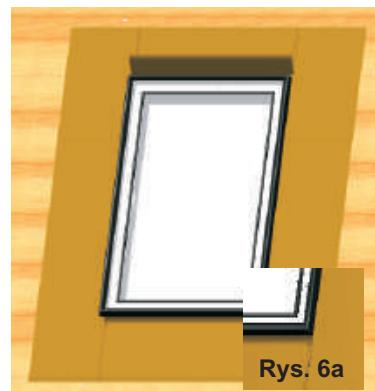
Zamocowany w ościeżnicy kołnierz uszczelniający przykryć uszczelką naramową, wciskając ją w rowek ościeżnicy jak na rys. 6a.
