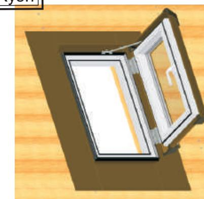
W odwrotnej kolejności jak na rys. 3 włożyć skrzydło w ościeżnicę - dokładnie osadzając piloty zawiasów **D** i ogranicznika w otworach ościeżnicy. Dokręcić wkręty zaciskowe momentem 2,5 Nm.
