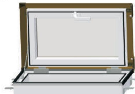
Przed przystąpieniem do montażu, położyć wyraz dachowy na miękkim podłożu (tektyra, styropian).
