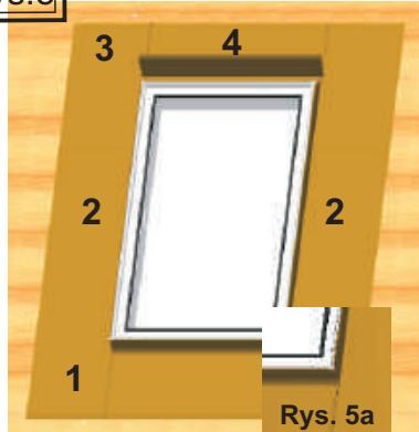
W celu zamontowania kołnierza uszczelniającego należy wyjąć uszczelkę naramową, zamocować kolejno elementy kołnierza jak na rys. 5a.
